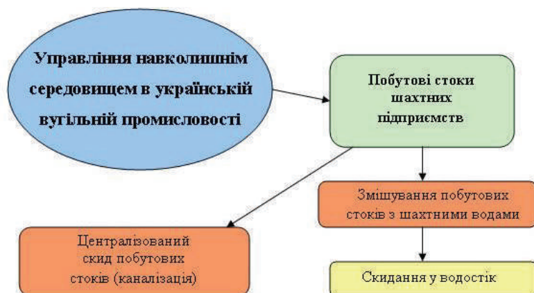
Рис. 8. Діаграма зв'язків на якій відображено поводження з побутовими відходами.
