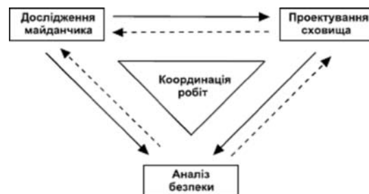
Рис. 1. Прямі (суцільні) і зворотні (пунктирні лінії) інформаційні зв'язки між роботами з дослідження майданчика, проектування і аналізу безпеки геологічного сховища [6].
