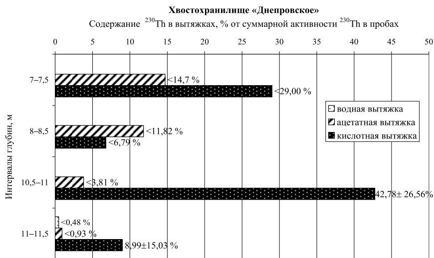
Рис. 2. Формы нахождения ^{230}\text{Th} в разрезе хвостохранилища «Днепровское»
