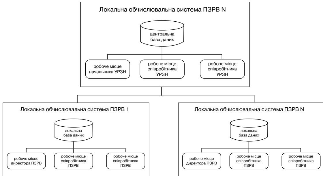
Рис. 2. Схема функціональної структури
